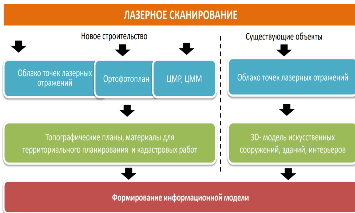
Рисунок 2. Место лазерного сканирования в процессе формирования информационной модели объекта
