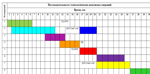
Рис. 4.3. Циклограмма управления и работы автоматизированного оборудования утюжильной вакуумной установки ВТО для образования и закрепления формы детали спинки мужского пиджака
